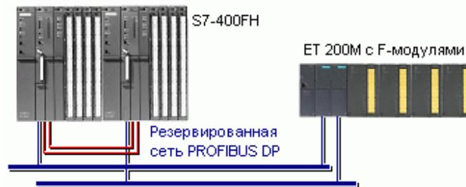
**Конфигурация на основе S7-400FH с полным резервированием периферийных устройств**
